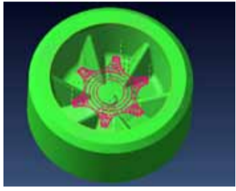
Hybridní dokončování – kombinované obrábění strmých i mělkých oblastí obrobku jako jedna dokončovací strategie
